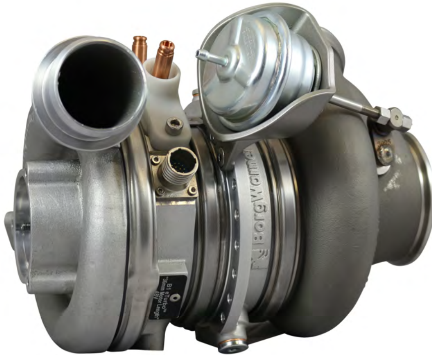
Bild 4. Beim innovativen 48-Volt-eTurbo™ von BorgWarner sind ein ultrahochdrehender Elektromotor und ein Turbolader miteinander kombiniert, um für zusätzliche Aufladung zu sorgen oder den Abgasstrom in elektrische Energie zu verwandeln.
