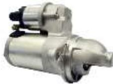
Pesando sólo 2 kg, el motor de arranque de alta velocidad (HS) de BorgWarner puede alcanzar hasta 1,4 Kw de potencia y es capaz de acelerar el motor de 0 a 350 RPM en menos de 0,5 segundos.
