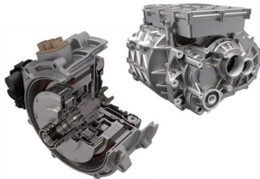
「第 10 回 EV・HEV 駆動システム技術展～EV JAPAN～」で展示されるボルグワーナーの先進技術 P2 ハイブリッドモジュール(左)と統合電動ドライブモジュールの iDM(右)
